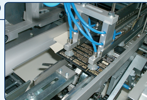
Gruppo formatore astuccio Box opening device
