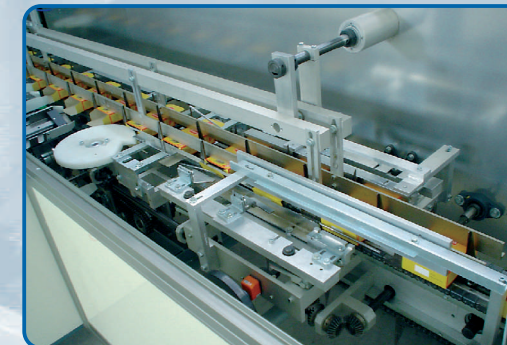
Dispositivo di chiusura lembi Flaps closing device
