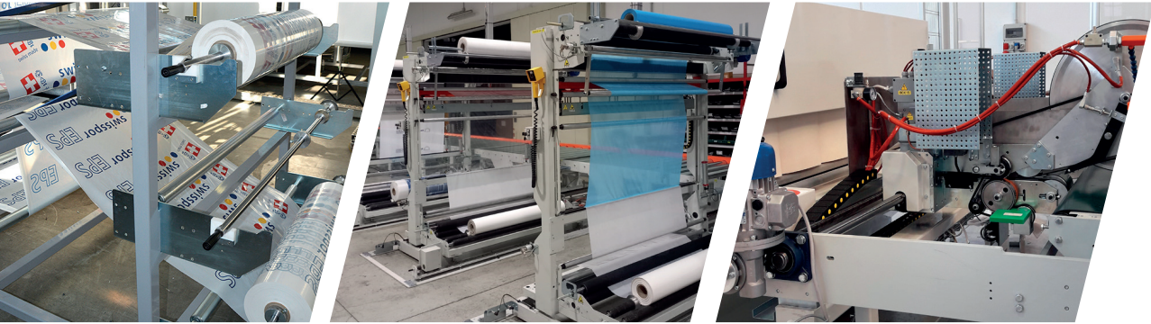
Portabobine multiple a 90° con barre di saldatura, facile giunzione manuale delle bobine Multiple film reels holders at 90° with welding bars for easy manual reels splicing
