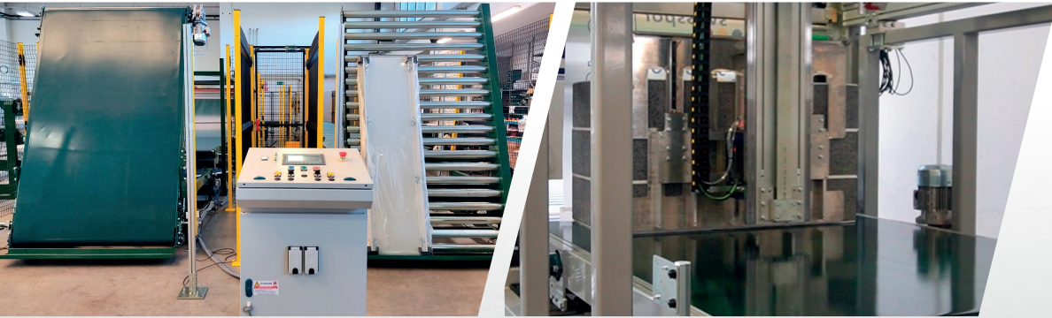
Automazione di linea (trasportatori supplementari, elevatori, trasportatori basculanti per carico e scarico) Line automation (extra conveyors, lifting conveyors, tilting conveyors for loading and unloading)
